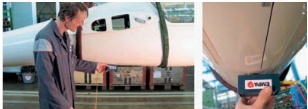
Prüfingenieur beim Check des Fahrwerkes eines Segelflugzeuges. Durch die drahtlose Energieversorgung (Box) kann das Landefahrwerk im eingebauten Zustand überprüft werden (Fahrwerk ist im Rumpf eingezogen).
