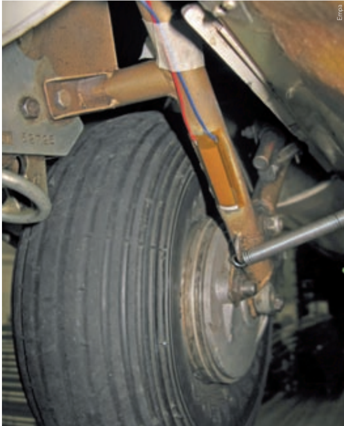
Landefahrwerk eines Segelflugzeuges mit einem piezoelektrischen Element (orange) zur Überwachung der Metallverstrebung.
